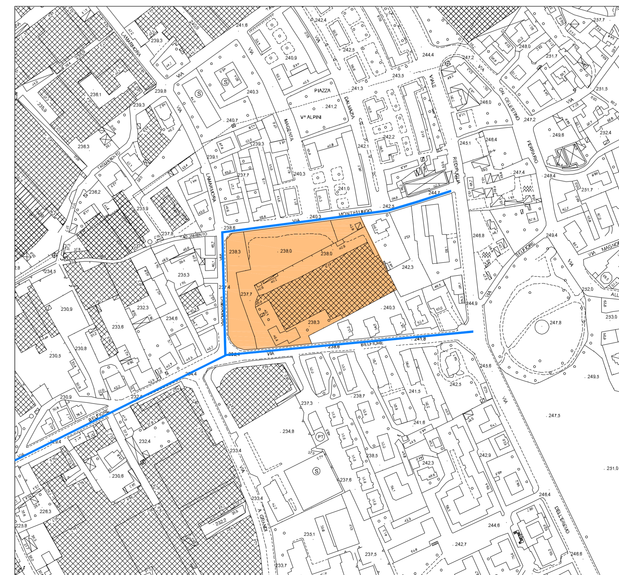
Stato attuale: sottoservizi tecnologici - RETE ENEL - scala 1:2000
